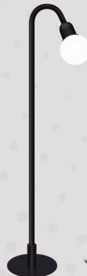
BALIZADOR SPHERA GLOBE 1373 Com base Porta lâmpada: 1 x G9 Halopin Difusor: Globo de vidro branco opalino Ø 100 mm Luminária total: Ø 200 x ¤ 800 mm Base: Ø 107 x 3 mm
