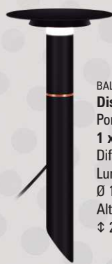
BALIZADOR Disc 1356 Porta lâmpada: 1 x GU10 MR11 Difusor: Acrílico Luminária: Ø 150 x ¢ 30 mm Altura livre: ¢ 420 mm
