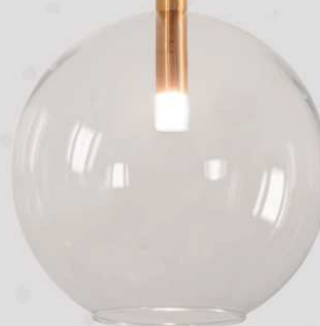
PENDENTE KAEL 1979 Porta lâmpada: 1 x G9 Halopin Difusor: Acrílico fosco cavado Ø 25 mm Difusor externo: Globo de vidro transparente Ø 250 mm Luminária: Ø 250 x 650 mm Base de teto: Ø 120 x 15 mm Cabo de alimentação: \pm 2 m (regulável)
