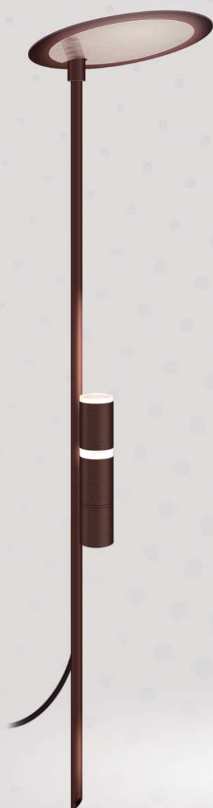
BALIZADOR REFLET 1377 Porta lâmpada: 1 x GU10 MR11 Difusor: Acrílico Luminária: Ø 38 x ¢ 150 mm Refletor: Ø 200 mm Altura livre: ¢ 670 mm
